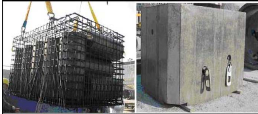
Figure 4 Colis de graphite à l'étude par EDF
