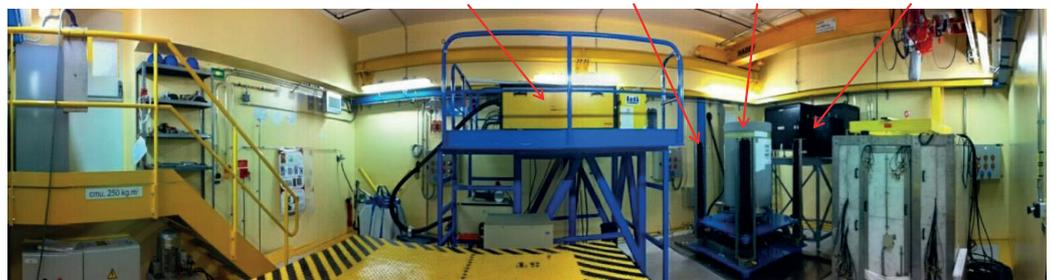
► Tomographe à haute énergie de l'installation CINPHONIE du CEA Cadarache. L'installation est implantée dans une casemate blindée enterrée. Elle peut accueillir des conteneurs de déchets allant jusqu'à 5 tonnes pour produire des examens tomographiques ou radiographiques avec une résolution spatiale de quelques millimètres.
