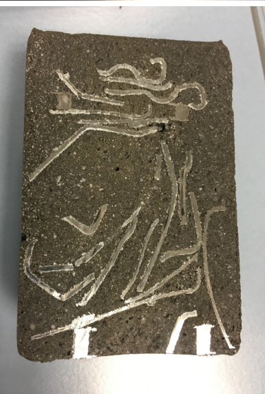
► Essais de conditionnement d'éléments métalliques au sein de matrices cimentaires incorporant le piègeur de tritium MnO_2/Ag_2O .
