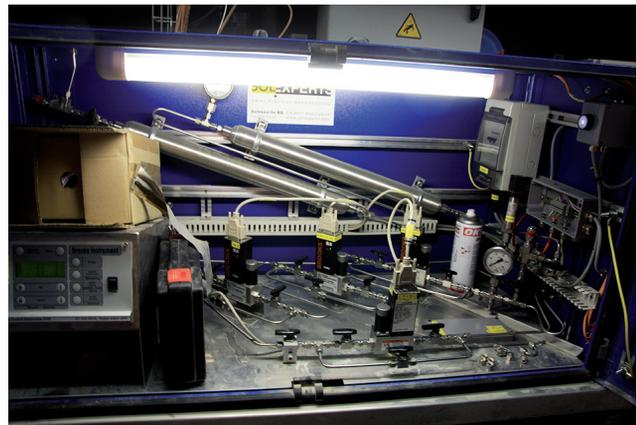
Les pressions interstitielles (ou pressions de l'eau) dans les 5 chambres de mesure. Dans la chambre d'essai, on mesure la perméabilité au gaz de la roche au cours de l'injection de gaz ainsi que la perméabilité à l'eau de la roche avant et après l'injection de gaz.
