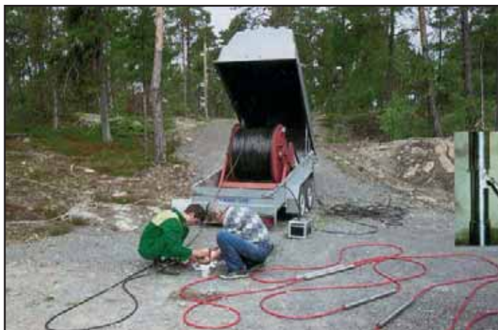
Source sismique (à gauche) et chaîne de 8 géophones avant descente dans un forage (à droite)
