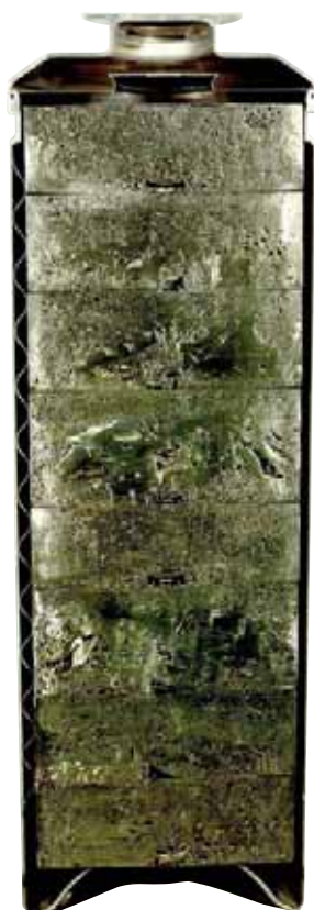
Ecorché (maquette) d'un colis CSD-C montrant l'empilement de galette de déchets compactés
