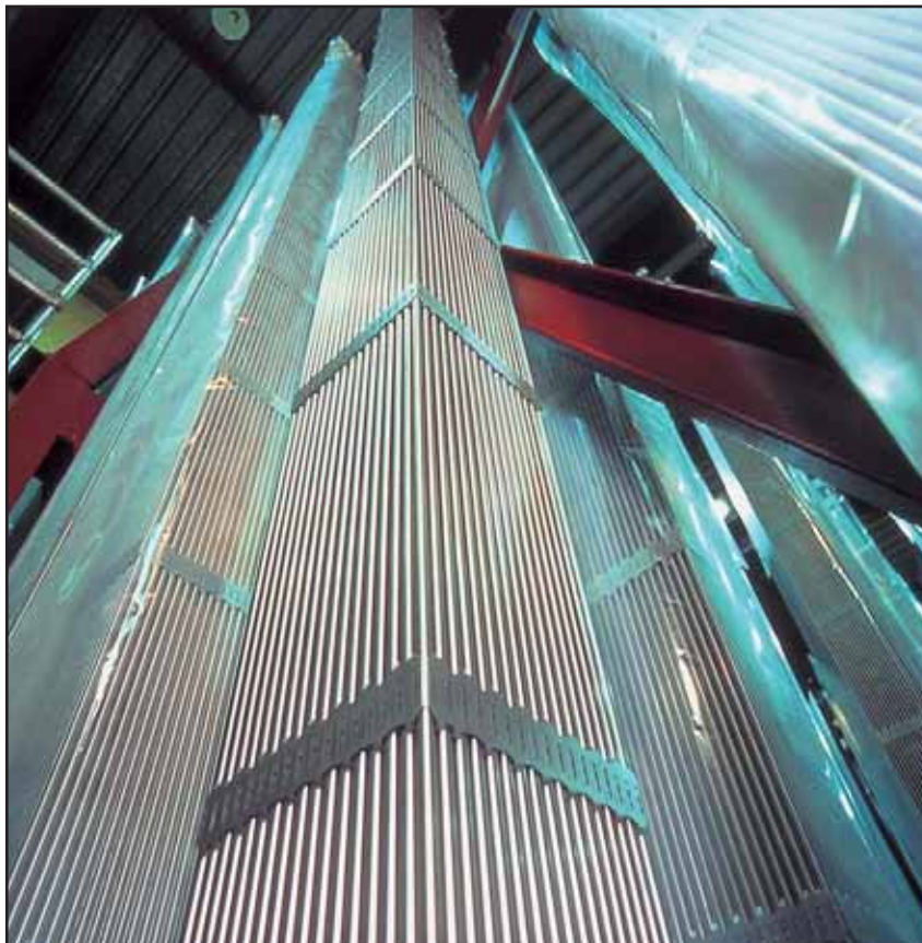
Assemblages de combustibles
