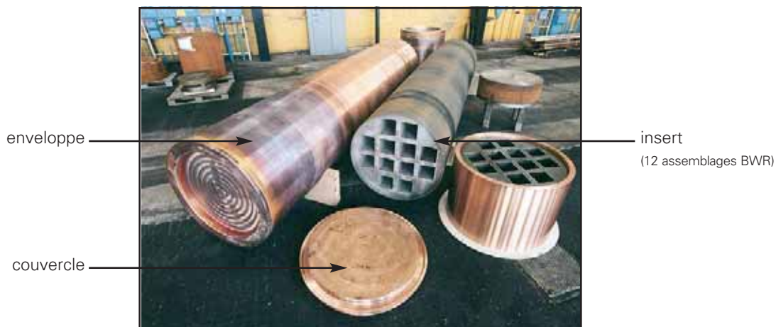
Vue de l'enveloppe en cuivre et d'un insert pour des assemblages BWR (source SKB)
