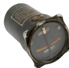
Cadran d'avion radioactif.
