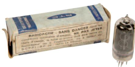
Tube électronique radioactif.
