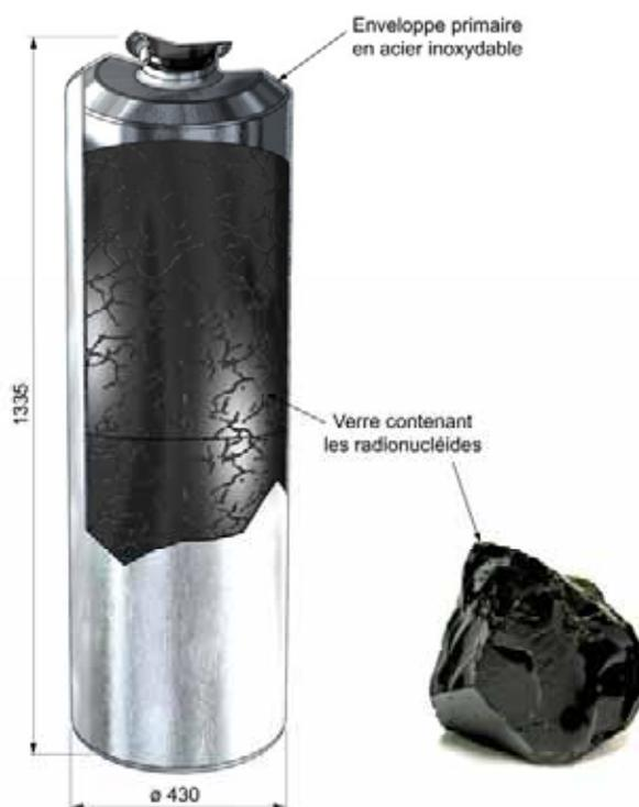
Figure 2.3.1 Schéma d'un colis primaire de déchets C vitrifiés avec écorché et photographie montrant la matrice vitreuse
