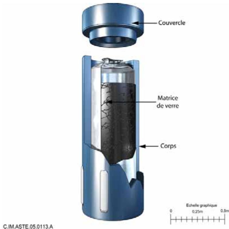
Figure 2.4.4 Schéma d'un colis de stockage de déchets C
