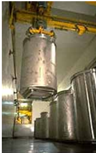
Figure 2.1-4 Fût en inox de 1800 litres contenant des déchets de structure cimentés
