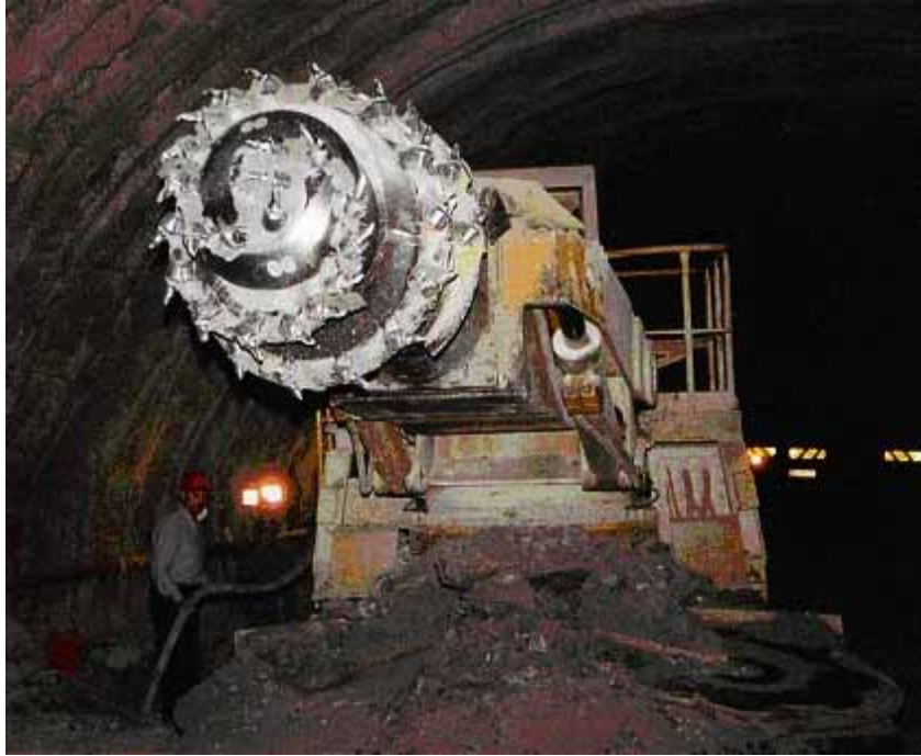
Figure 3.7-3 Exemple de machine à attaque ponctuelle de grande puissance
