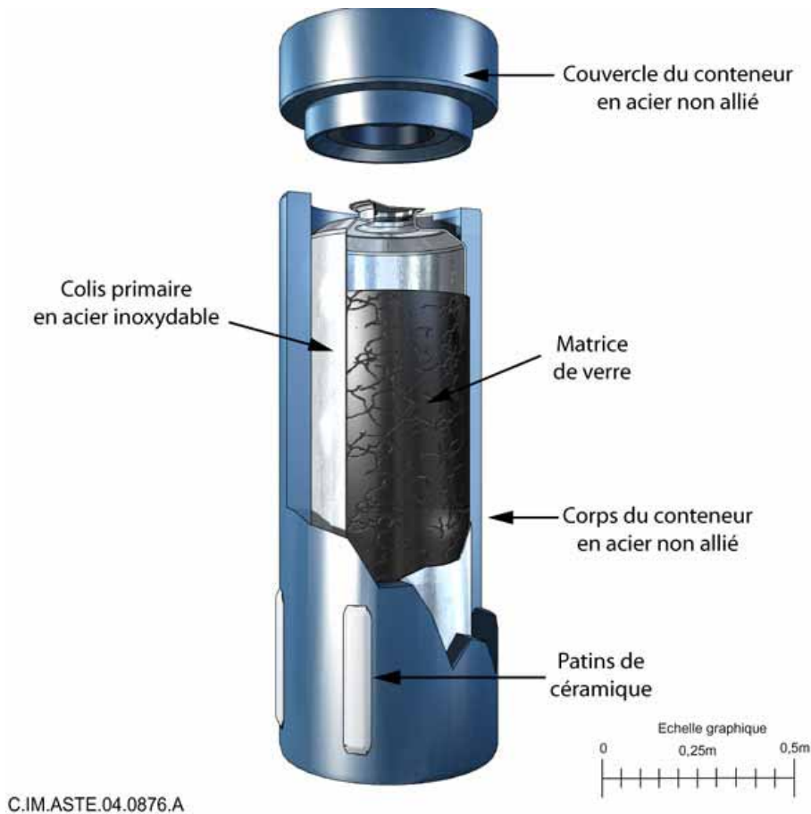
Figure 3.7-9 Schéma de principe du colis de stockage des colis-type de déchets C vitrifiés (verre, conteneur et surconteneur)
