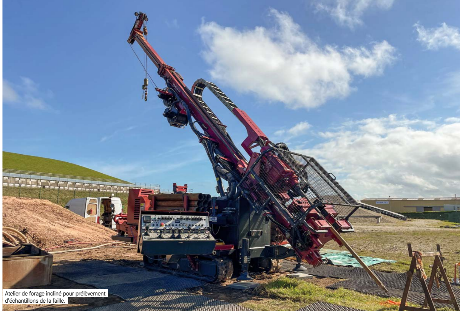
Atelier de forage pour pose de piézomètre.
