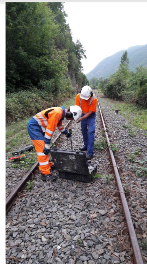
Figure 2-9 Exemple d'essai pénétromètre dynamique (Source : Egis)
