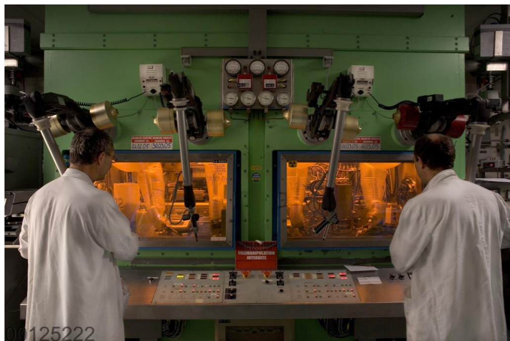
Figure 2-2 Fabrication par voie sèche (broyage, pressage, frittage et gainage) de combustibles d'études, cibles de transmutation et matrices de confinement. © A. Gonin/CEA
