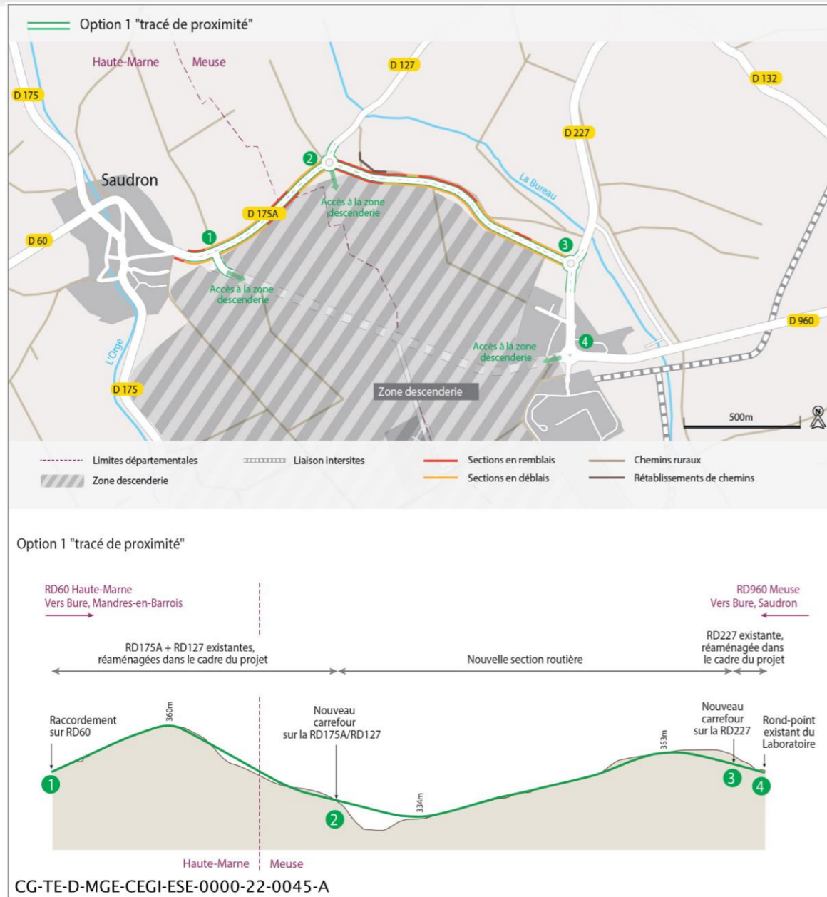
Figure 3-117 Opération de déviation de la route départementale D60/960 - Option 1 « Tracé de proximité »
