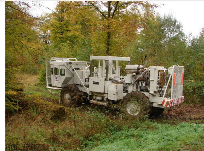
Figure 2-40 Camion vibrant utilisé lors de la campagne de mesure sur la ZIRA
