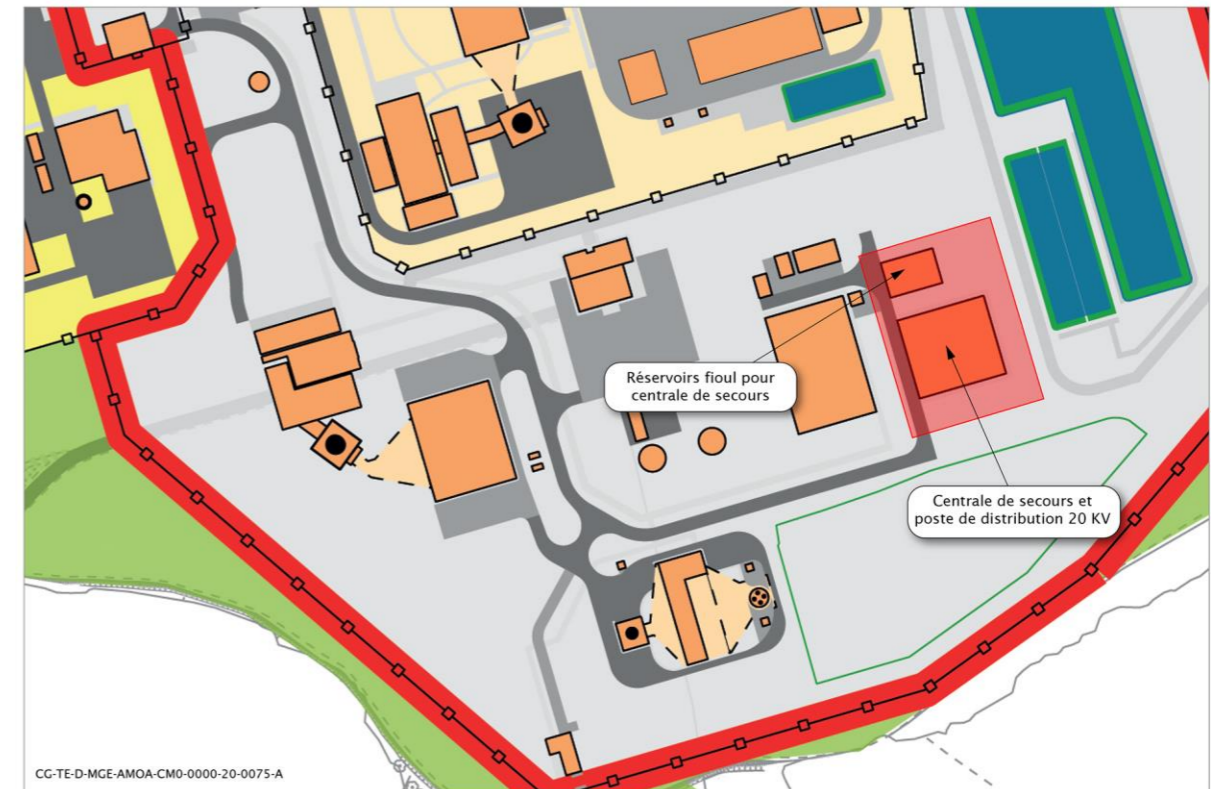
Figure 3-61 Localisation de la centrale de secours et de ses réservoirs fioul en zone puits
