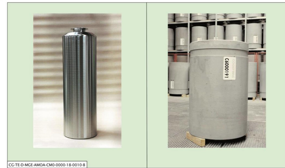
Figure 1-8 Exemples de colis de déchets radioactifs – déchets radioactifs de haute activité (HA) vitrifiés à gauche et déchets radioactifs de moyenne activité à vie longue (MA-VL) cimentés à droite
