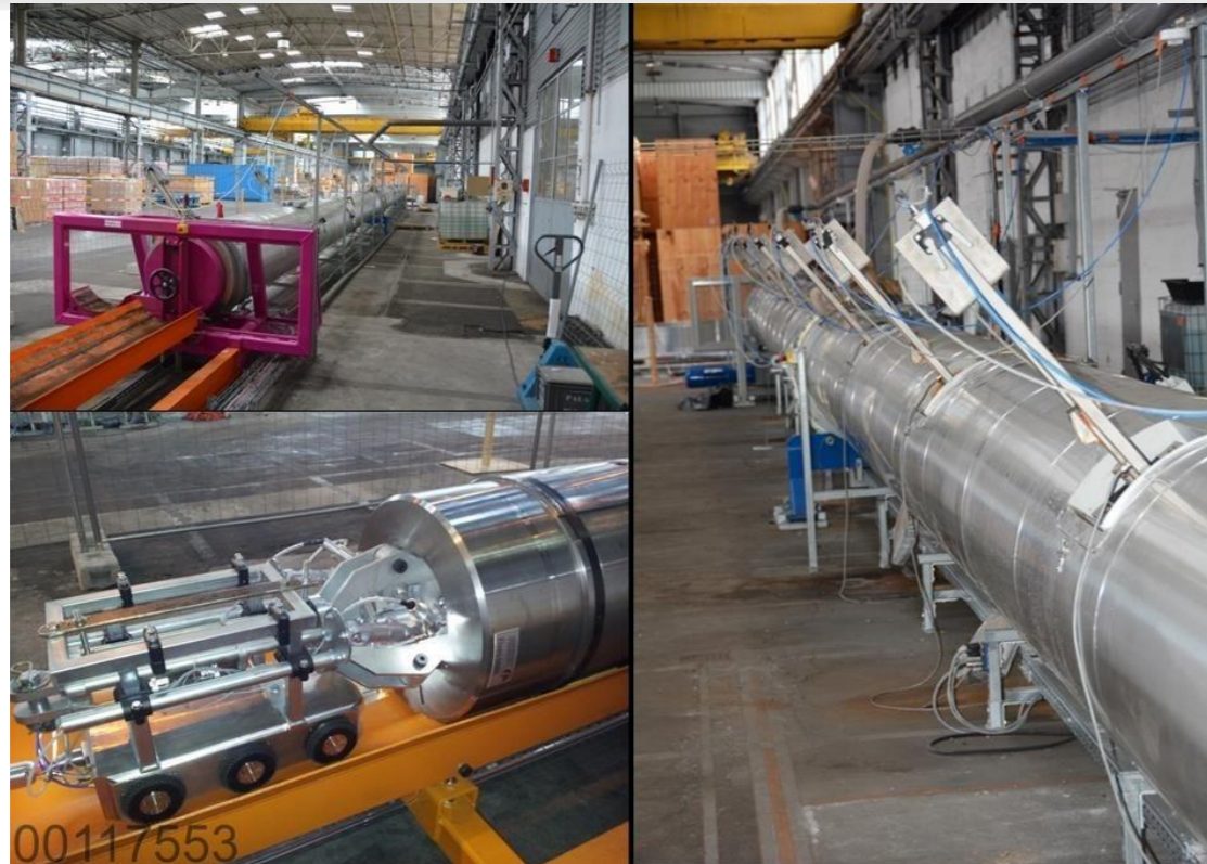
Figure 4-5 Banc d'essai de récupérabilité de colis de stockage HA (source : Andra)
