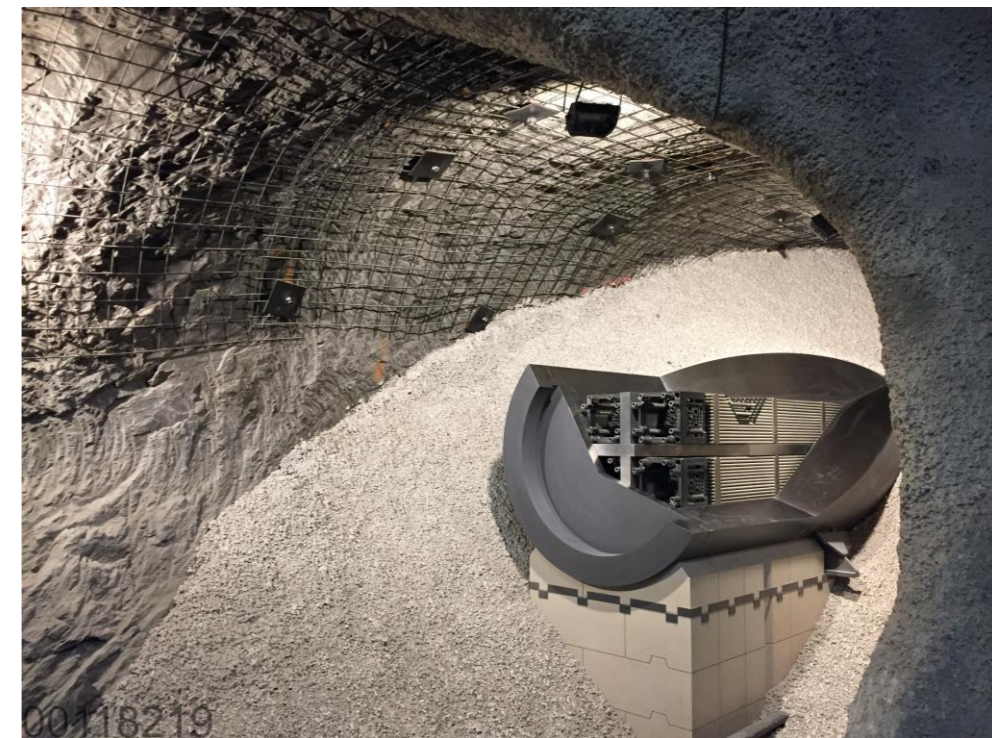
Figure 2-19 Laboratoire souterrain du Mont-Terri : maquette d'une alvéole de stockage pour le combustible usé
