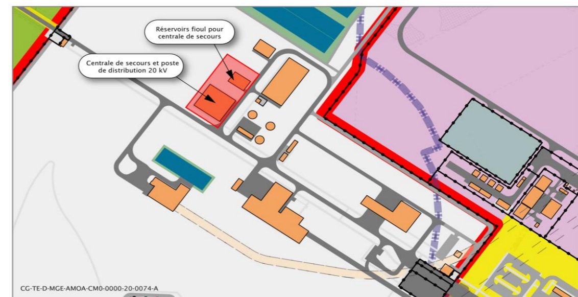
Figure 3-29 Localisation de la centrale de secours et de ses réservoirs fioul en zone descendrie
