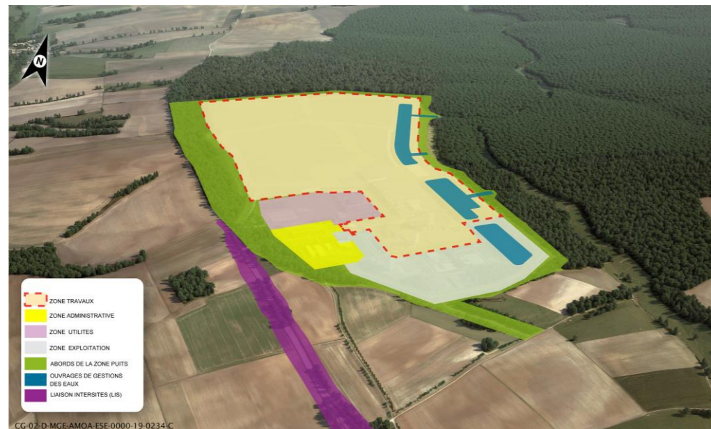
Figure 3-43 Localisation des installations de la zone travaux
