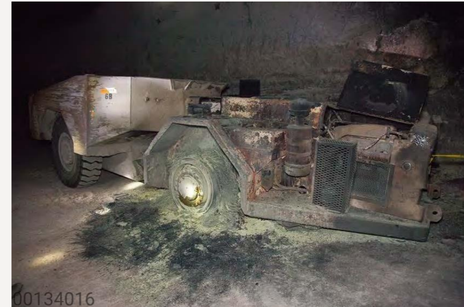
Figure 2-12 Photographie du camion incendié au WIPP
