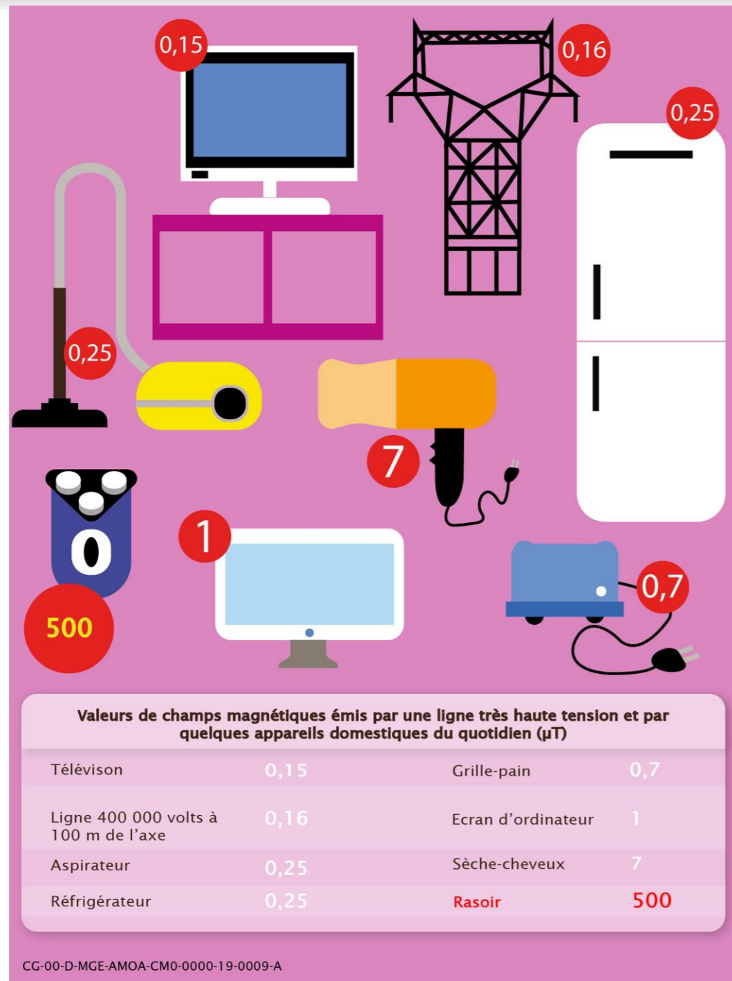
Figure 13-12 Champs électriques et magnétiques émis par des appareils et installations de la vie quotidienne
