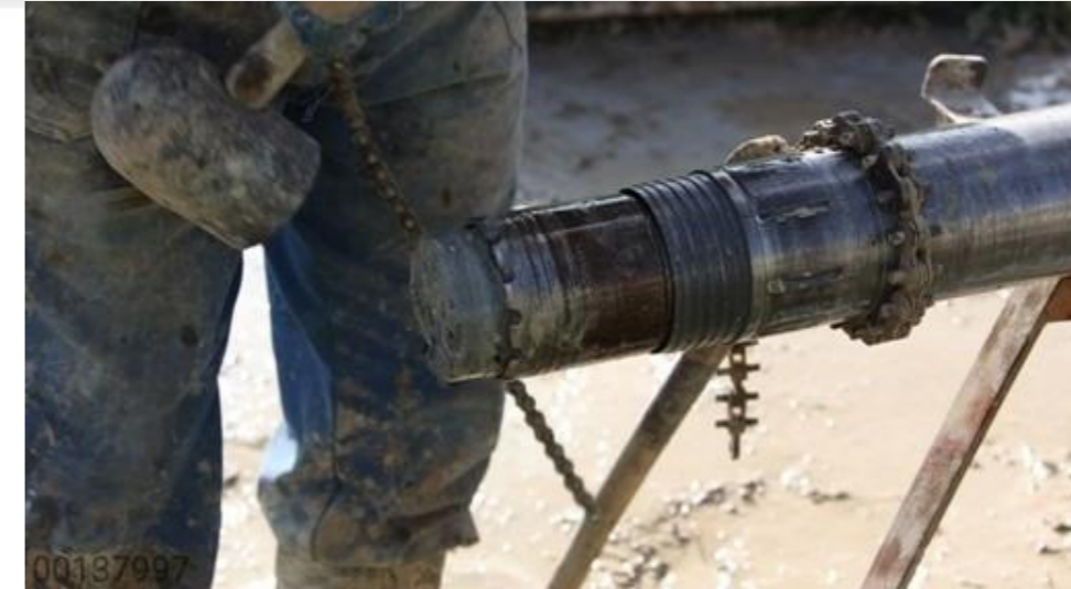
Figure 14-96 Exemple de d'extraction de « carottes » pour étudier les caractéristiques du sol ou encore en mesurer sa résistance à la pression. (source ANDRA – 67 forages réalisés sur l'emprise de l'ancienne voie ferrée entre Gondrecourt-le-Château -55- et Cirfontaines-en-Ormois -52- et de la voie nouvelle entre Cirfontaines-en-Ormois et Gillaumé (6))
