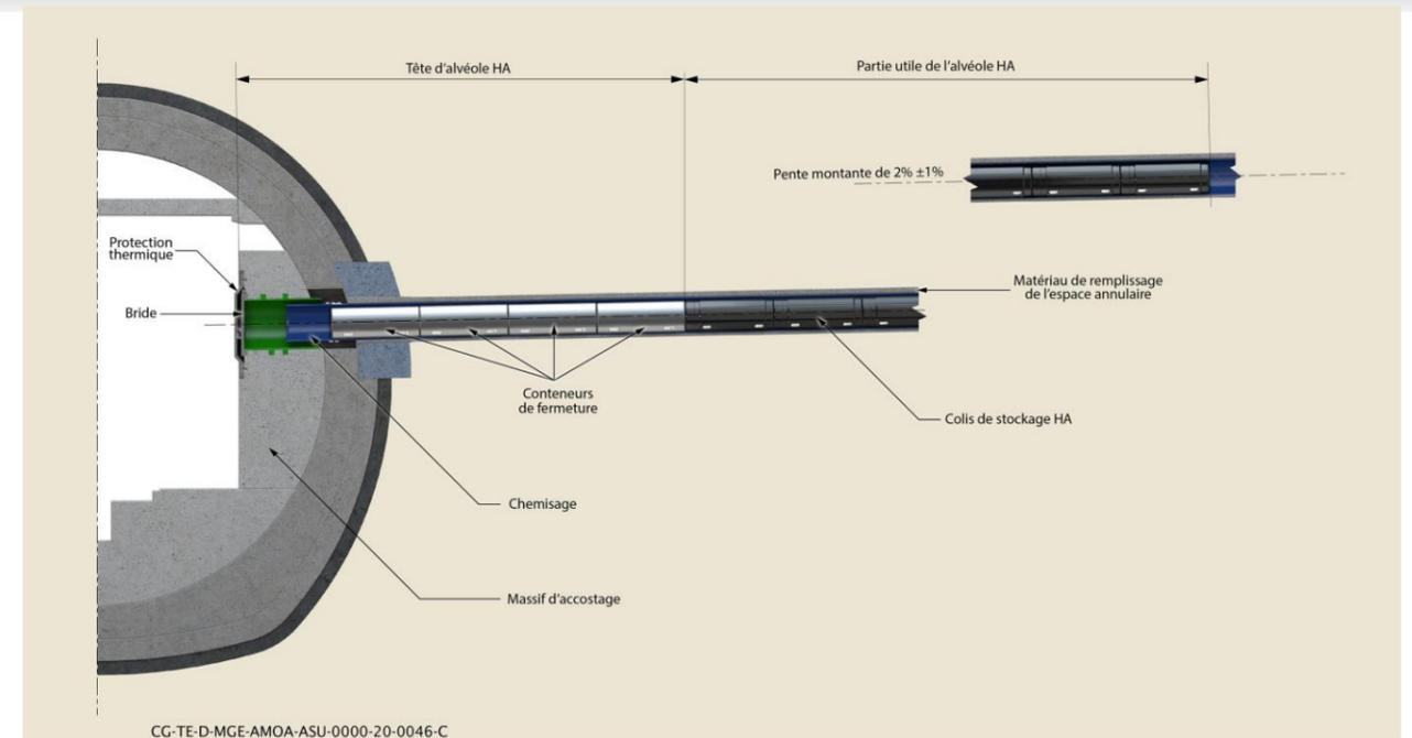
Figure 18-6 Schéma de principe d'un alvéole HA en attente de fermeture
