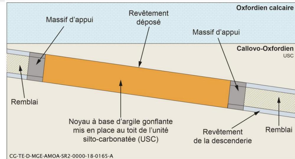
Figure 18-8 Principe de scellement en descenderie à titre illustratif
