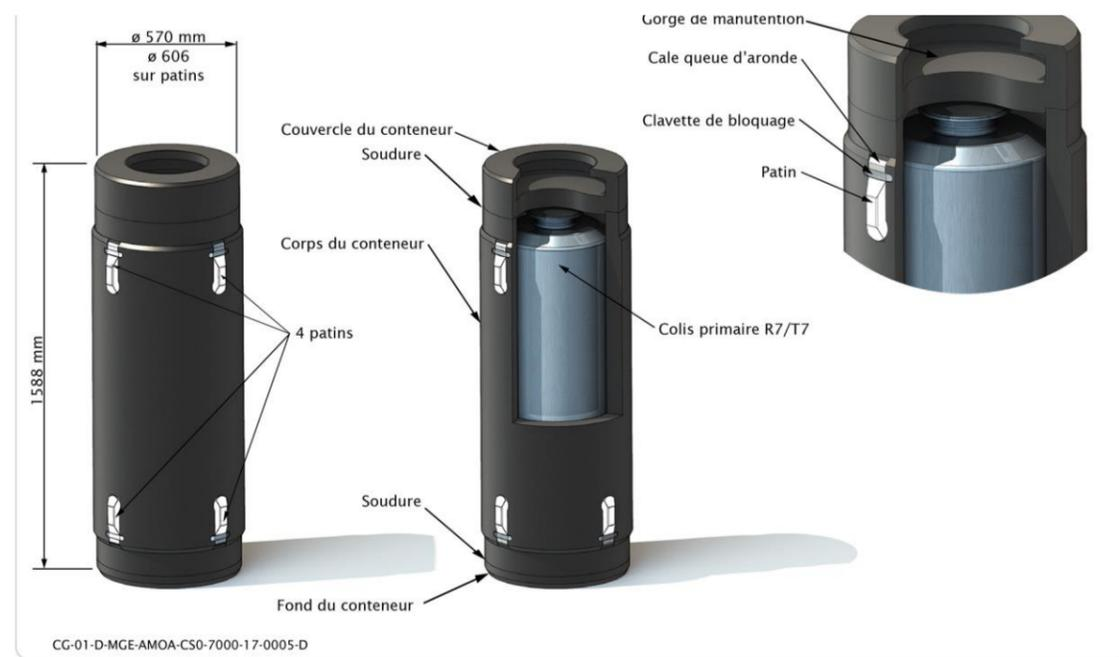
Figure 18-16 Illustration d'un colis de stockage des déchets vitrifiés avec son conteneur de stockage
