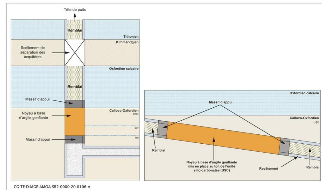
Figure 18-15 Schéma de principe des scellements des puits (à gauche) et des descenderies (à droite)
