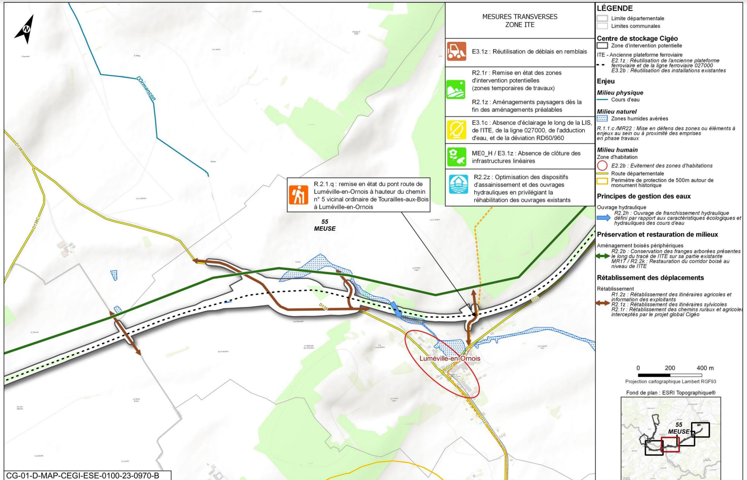
Figure 22-7 Synthèse des mesures sur l'installation terminale embranchée (ITE) du centre de stockage Cigéo (planche 2 sur 4)
