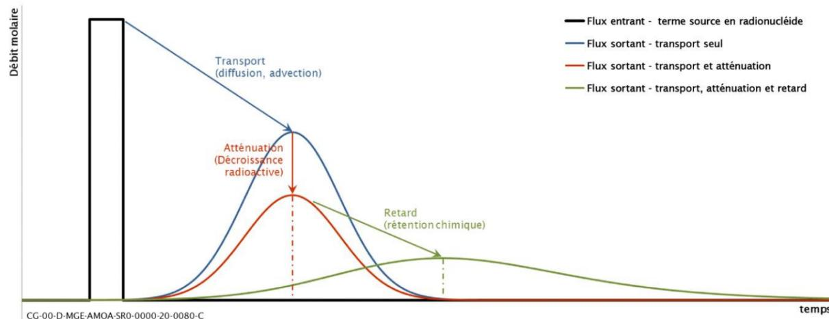
Figure 18-14 Schéma illustrant les processus de décroissance, atténuation et retard des radionucléides vis-à-vis de leur migration dans le temps
