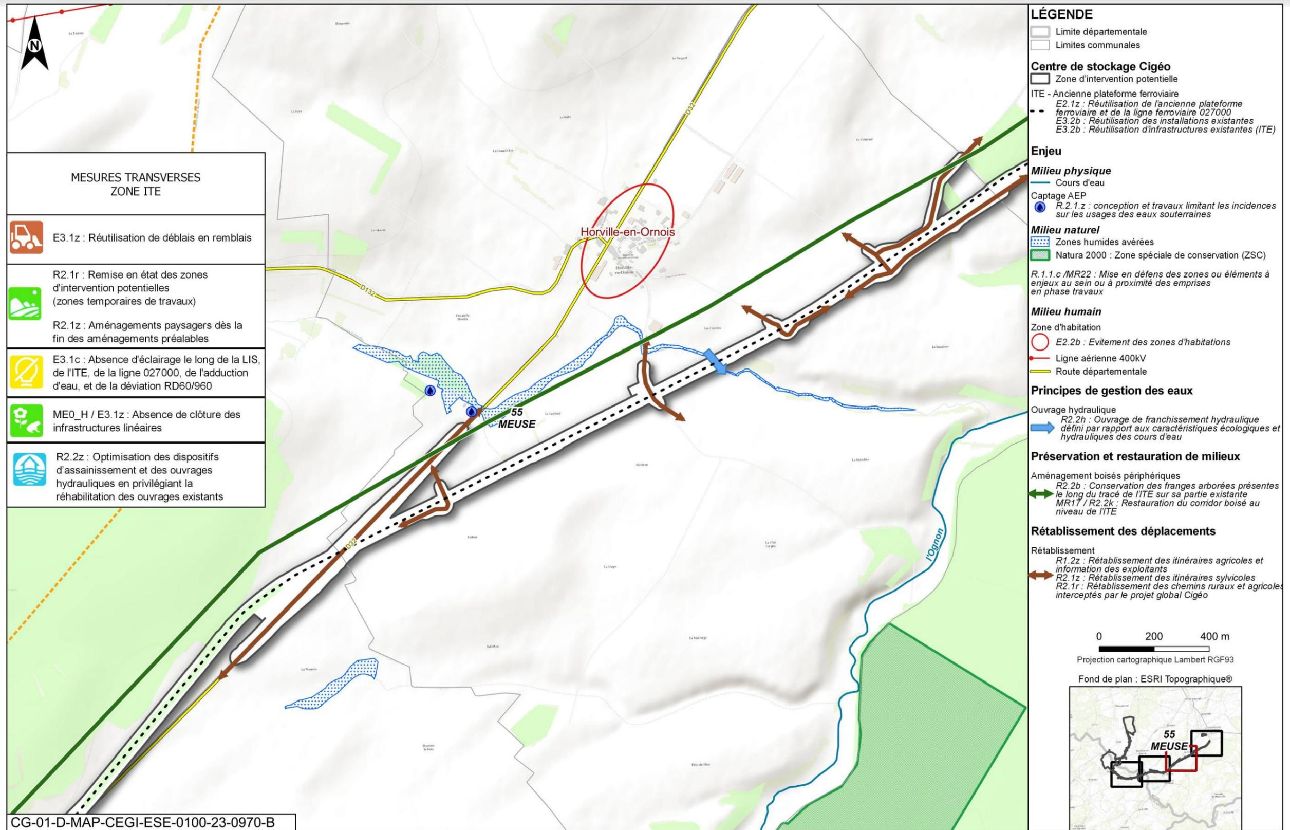
Figure 22-8 Synthèse des mesures sur l'installation terminale embranchée (ITE) du centre de stockage Cigéo (planche 3 sur 4)
