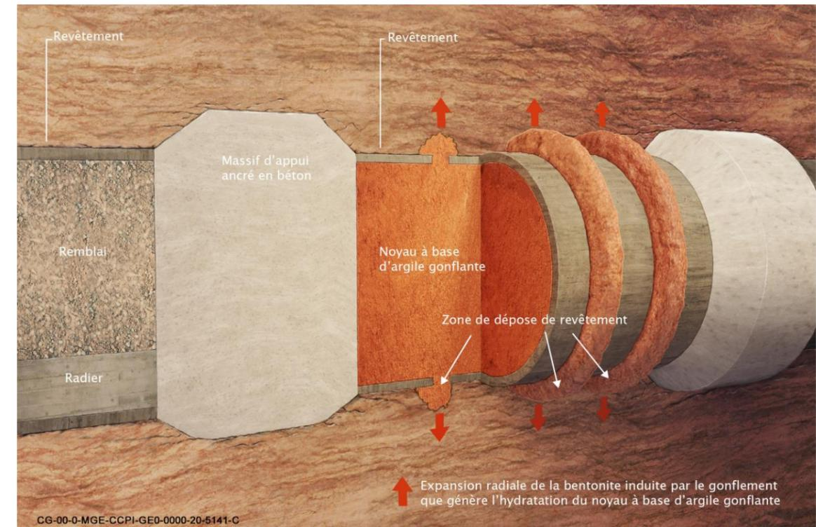
Figure 18-4 Schéma de principe illustratif d'un scellement de galerie de liaison - Vue en écorché
