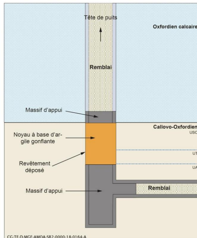
Figure 18-7 Principe de scellement d'un puits à titre illustratif
