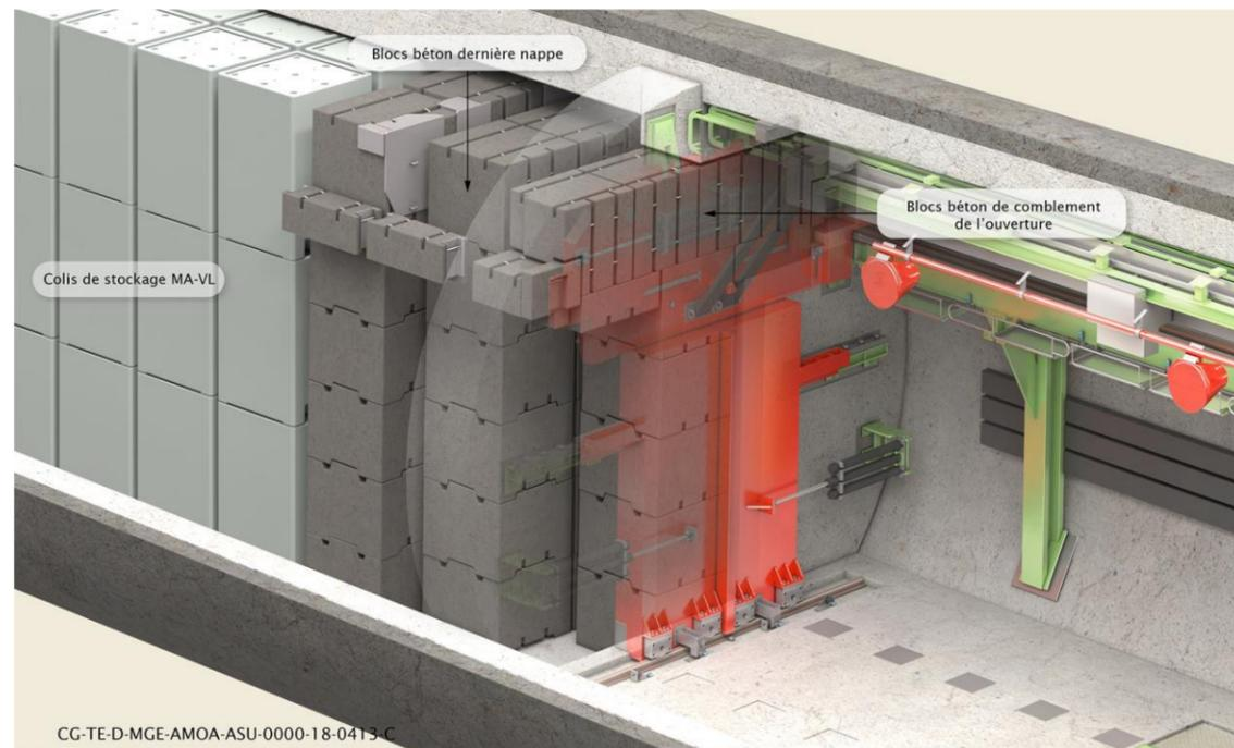
Figure 18-3 Blocs de béton constituant le mur de radioprotection mis en place au niveau des alvéoles MA-VL
