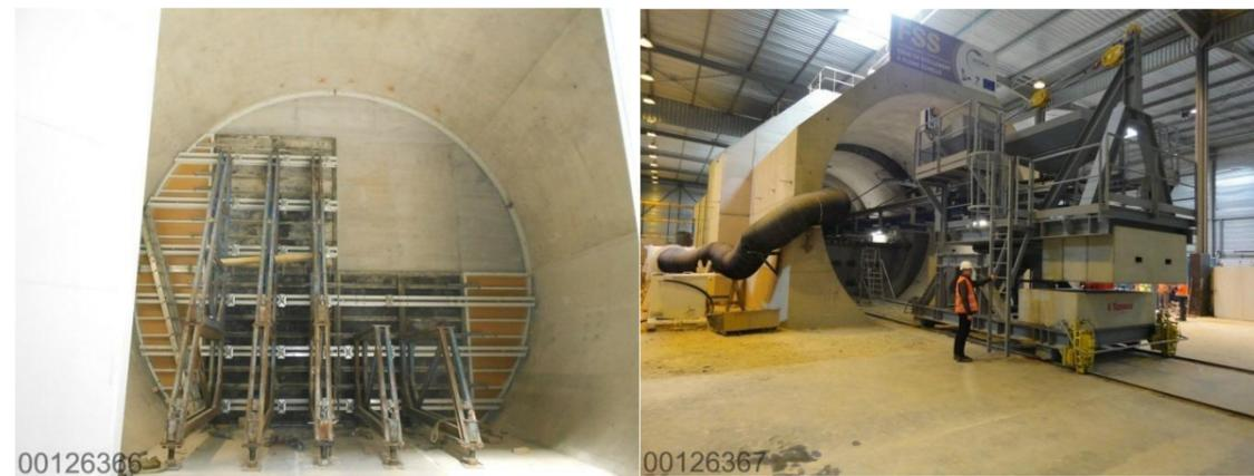
Figure 18-5 Photographies d'essais de réalisation d'un scellement de galerie, notamment FSS (FULL SCALE SEALING) – démonstrateur à caractère technologique en surface à Saint-Dizier (dép. 52)
