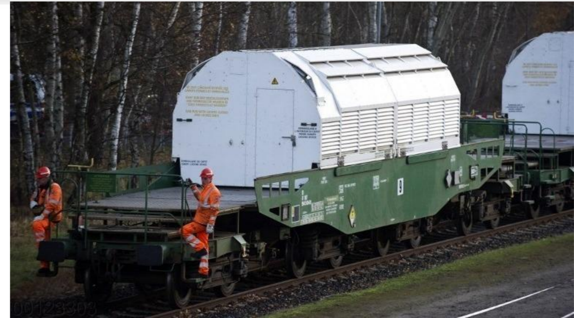
Figure 4-8 Photographie d'emballages de transport de déchets radioactifs sur un train
