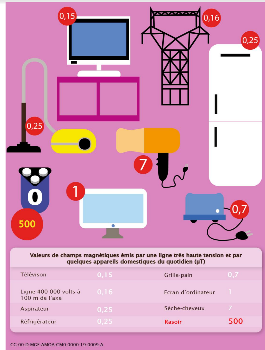
Figure 2-15 Champs électromagnétiques émis par des appareils et installations de la vie quotidienne
