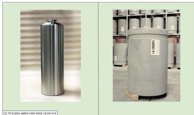
Figure 2-6 Exemples de colis de déchets - déchets de haute activité (HA) vitrifiés à gauche et déchets de moyenne activité à vie longue (MA-VL) cimentés à droite
