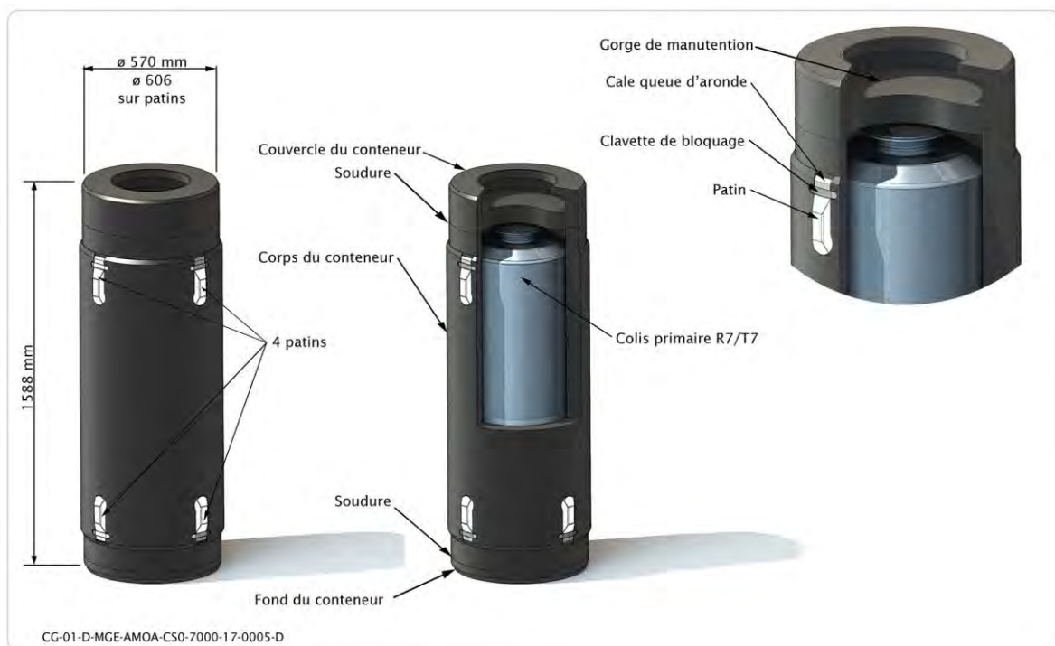
Figure 3-4 Illustration d'un colis de stockage de déchets vitrifiés HA avec son conteneur de stockage
