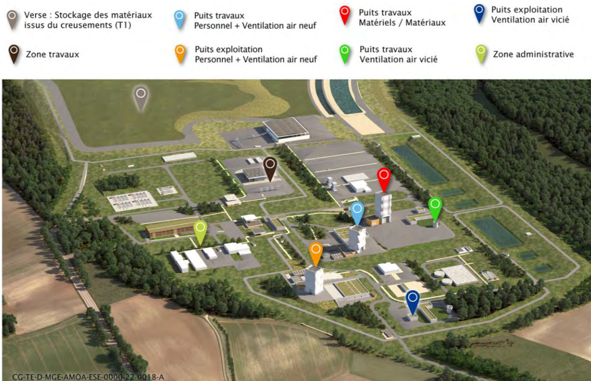
Figure 2-5 Vue de principe de la zone puits
