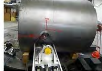
Mesure et vérification du niveau des contraintes résiduelles dans la zone détensionnée.
