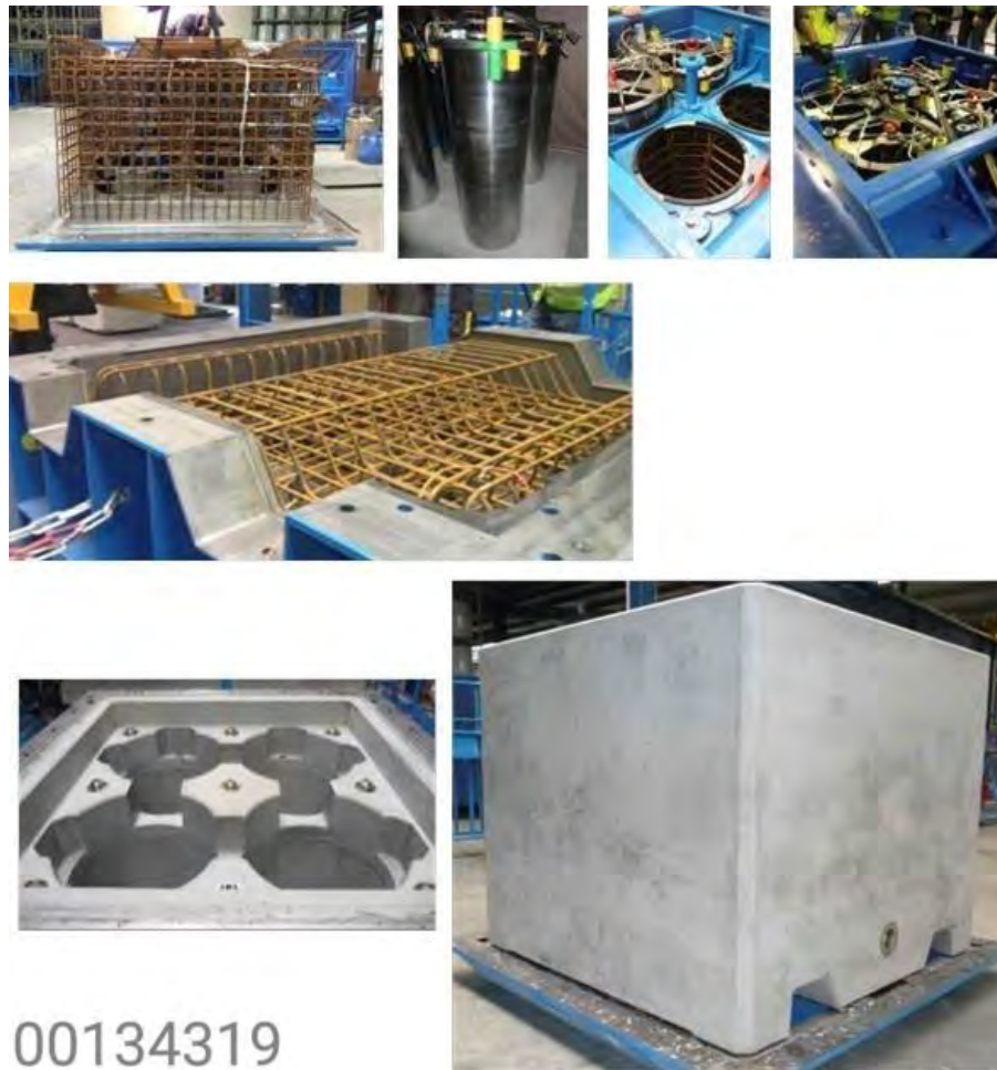
Figure 3-7 Photographies illustratives des étapes de fabrication de prototypes de conteneurs de stockage MA-VL
