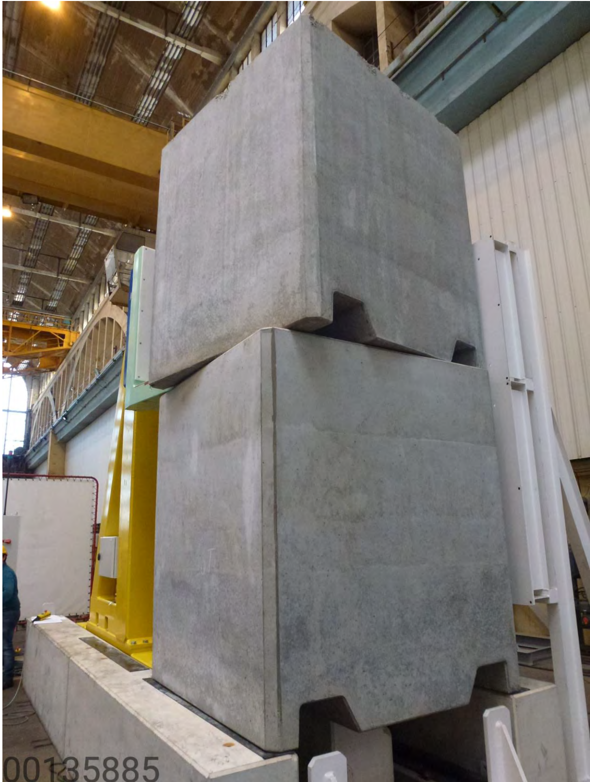
Figure 6-7 Photographie du banc d'essais de retrait de colis de stockage MA-VL
