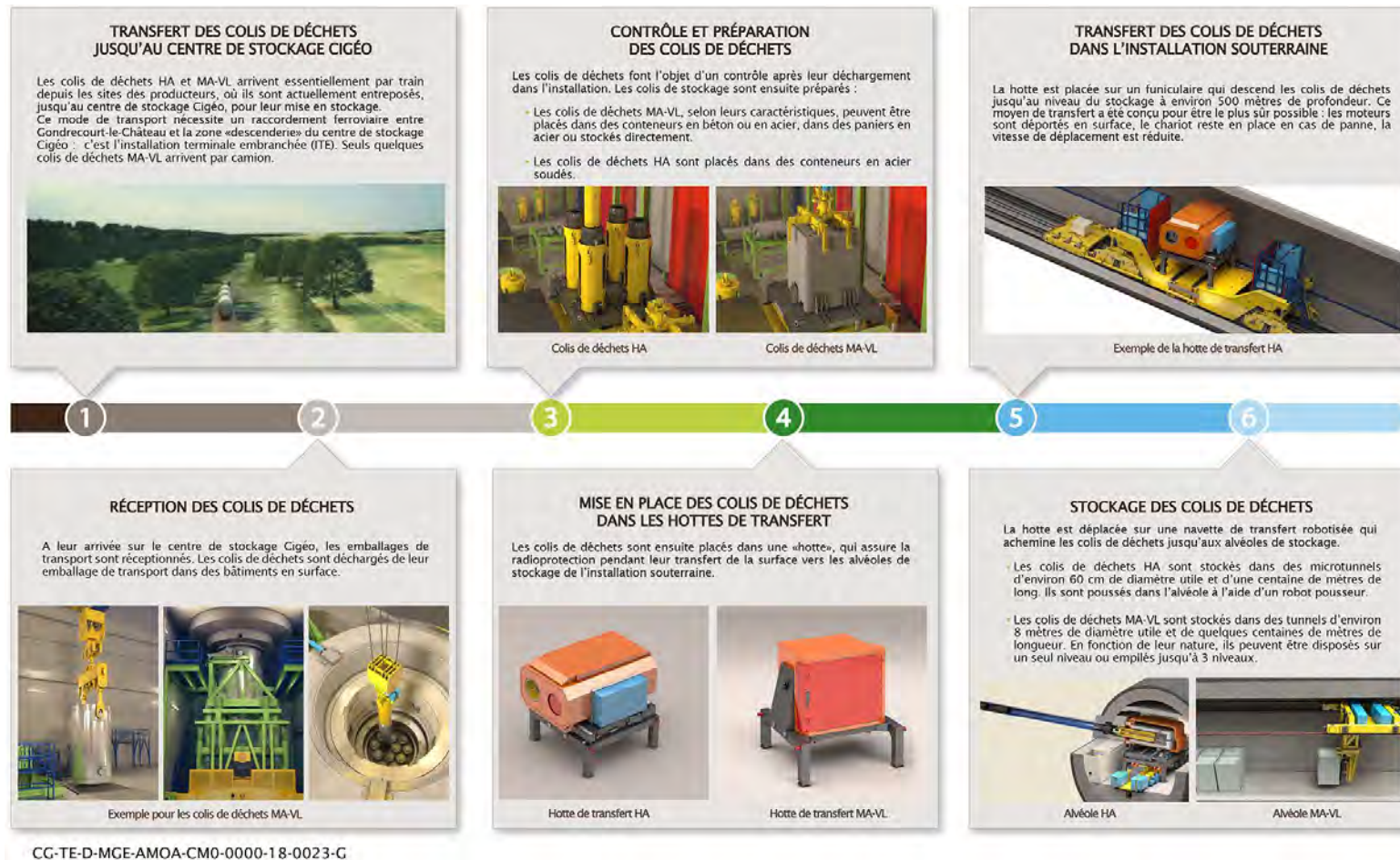
Figure 7-10 Cheminement des colis de déchets de leur arrivée à Cigéo jusqu'à leur emplacement de stockage
