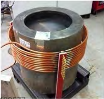
Traitement de détensionnement thermique local par induction de la zone soudée
