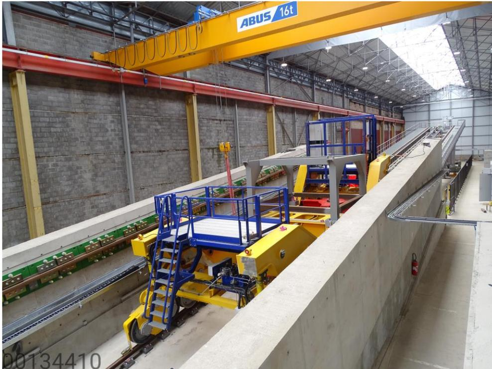
Figure 4-3 Photographie du banc d'essais du système de freinage du funiculaire
